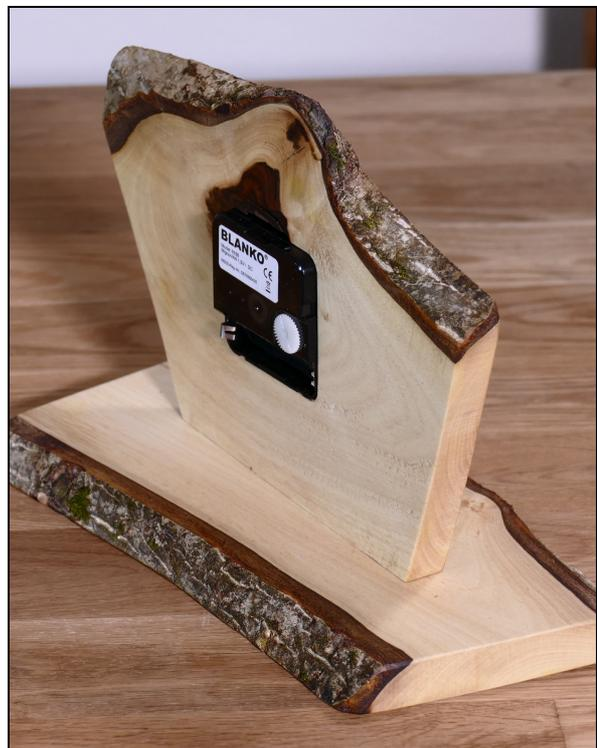
Uhrwerk sitzt in CNC-Einfräsung
